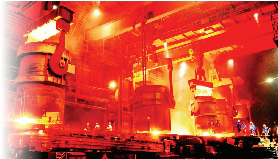
国机重装自主研制的8万吨大型模锻压力机下固定梁5包合浇,钢水总重693吨。 部门供图
