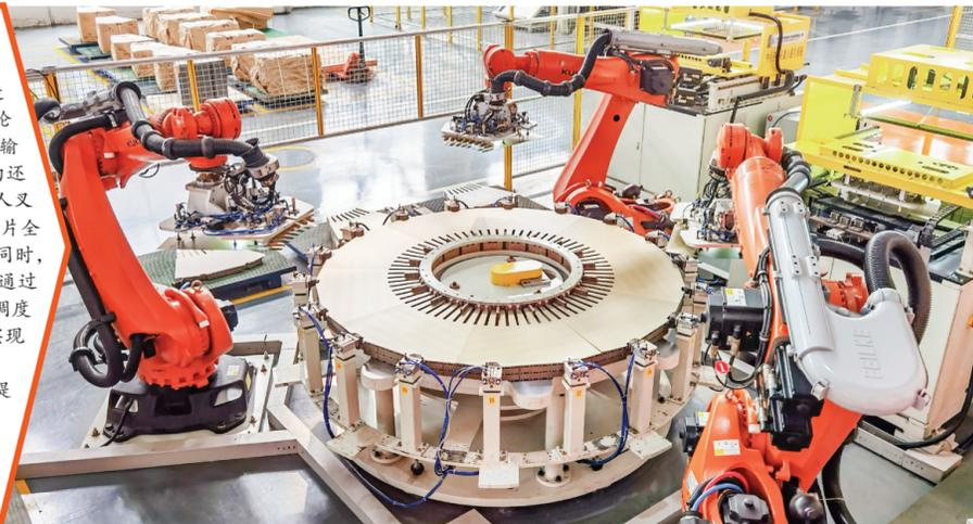
东方电机定子冲片全自动生产线有序运作。
